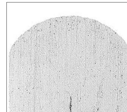
Фото 2.2: Образец, испытываемый на растяжение после загибания на 180°, без прокладки, параллельно направлению вальцевания
